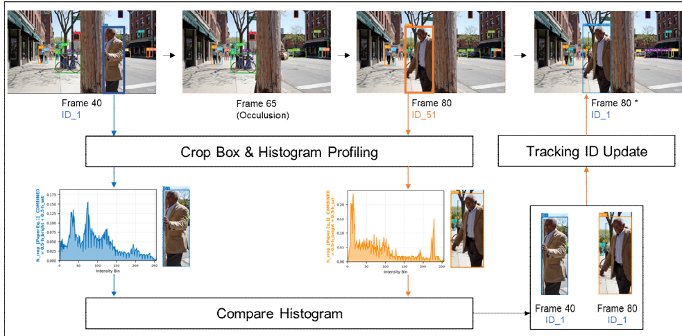
그림 2. 슬라이딩 윈도우 버퍼 기반 Crop Histogram Track ID 복원 과정 Fig. 2. Sliding window buffer-based Track ID restoration via crop histogram matching
