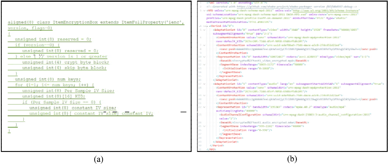
그림 3. CENC 암호화 구문 (a) CENC의 아이템 암호화 박스 (b) MPEG-DASH MPD에서의 CENC DRM 암호화 예시 Fig. 3. CENC encryption syntax (a) Item encryption box of CENC (b) Example of DRM encryption using MPEG-DASH MPD with CENC
