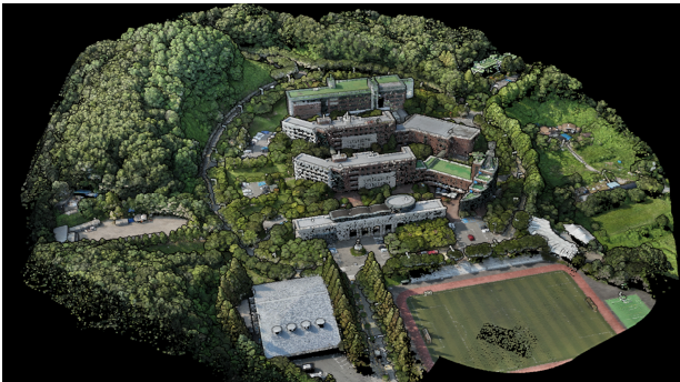
그림 4. 포토그래메트리 및 LiDAR 융합 기반 고밀도 포인트 클라우드 생성 결과 Fig. 4. High-Density Point Cloud Generated by Photogrammetry - LiDAR convergence
