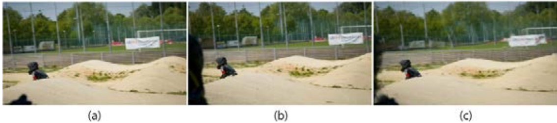
그림 5. 카메라 이동성으로 인한 배경 영역의 왜곡 (a) 54 th 프레임 (b) 56 th 프레임 (c) 보간된 55 th 프레임 Fig. 5. Artifacts of background area caused by camera mobility (a) 54 th frame (b) 56 th frame (c) Interpolated 55 th frame
