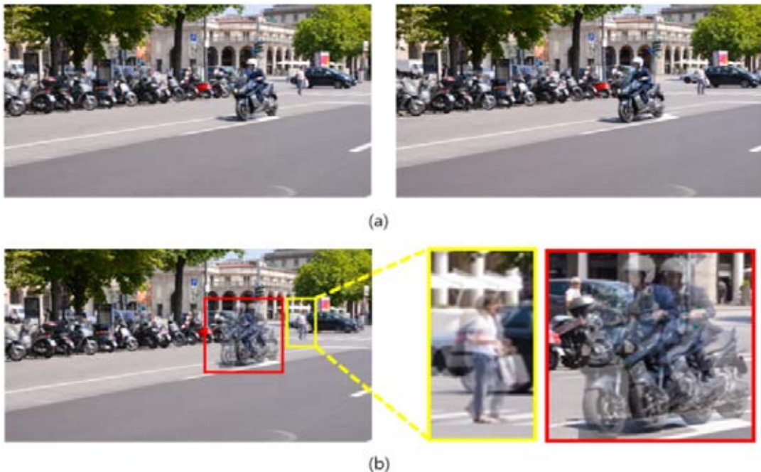
그림 3. 스티칭 예시 (a) 6 th 프레임 및 8 th 프레임 (b) 고스트 현상이 나타난 스티칭 영상 Fig. 3. Stitching Example (a) 6 th frame and 8 th frame (b) Stitching Image with Ghost Effect
