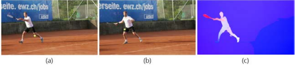
그림 1. 옵티컬 플로우 예시 (a) 16 th 프레임 (b) 18 th 프레임 (c) 프레임간 광학 흐름 Fig 1. Optical flow example (a) 16 th frame (b) 18 th frame (c) Inter-frame optical flow
