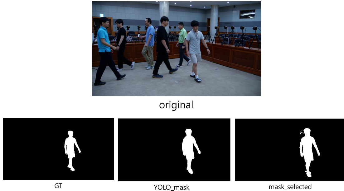
그림 5. 사용된 데이터 원본 (위), 데이터에 대한 참값 (좌하단), YOLO를 이용한 마스크 (중하단), SA3D를 이용한 마스크 (우하단) Fig. 5. Data Source (Top), Ground Truth (Bottom Left), Mask by YOLO (Bottom Middle), Mask by SA3D (Bottom Right)
