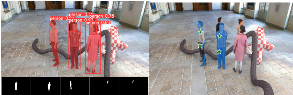
그림 1. 기존 2D 객체 분할 기술 적용 결과. YOLOv8(좌), SAM(우) Fig. 1. Results of applying existing 2D object segmentation techniques. YOLOv8 (left), SAM (right)
