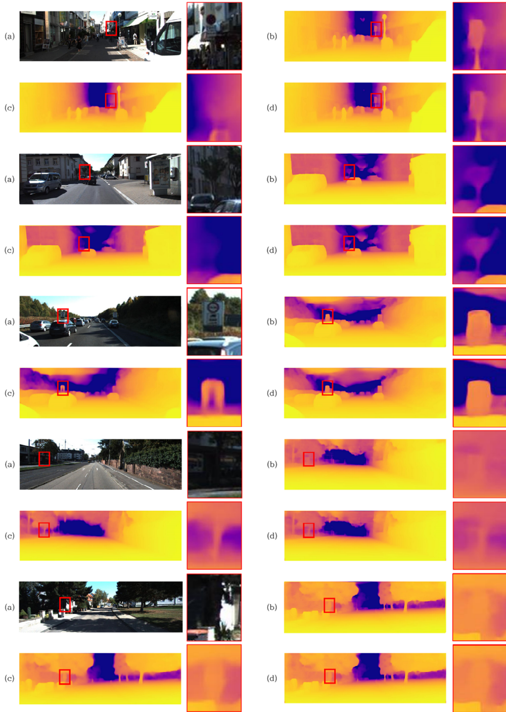
그림 3. KITTI 데이터셋 [14] 에 대한 단안 깊이 추정 결과, (a): 입력 이미지 (b): 고해상도(1024x320) 이미지 입력으로부터 생성된 SQLDepth [11] 의 깊이 지도 (c): 저해상도(640x192) 이미지 입력으로부터 생성된 SQLDepth [11] 의 깊이 지도 (d): 제안하는 방법으로부터 생성된 깊이 지도 Fig. 3. Results of monocular depth estimation on the KITTI dataset [14] (a): Input image (b): Depth maps of high-resolution(1024x320) inputs by SQLDepth [11] (c): Depth maps of low-resolution(640x192) inputs by SQLDepth [11] (d): Depth maps by the proposed method
