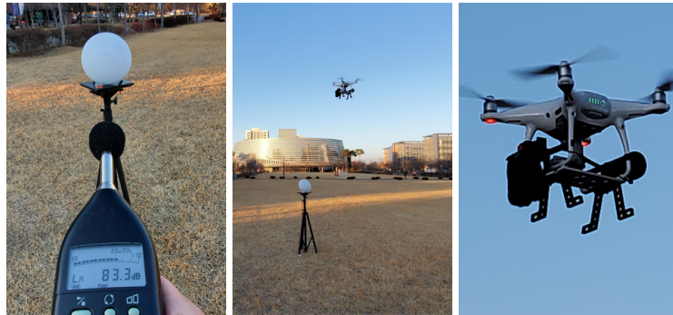
그림 3. 실제 드론 비행 중 소음 및 목표 음원 녹음 실험 상황 Fig. 3. Drone noise and target sound recording during actual drone flight
