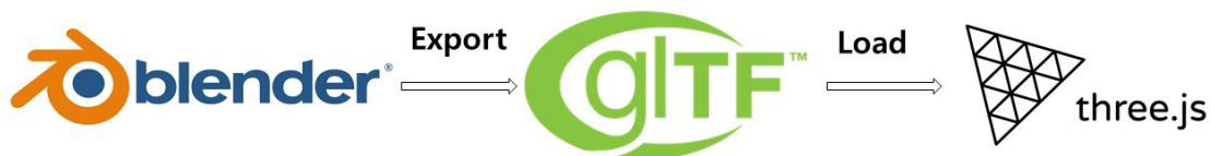
그림 2. Blender를 통한 디지털 트윈 표출 아키텍처 Fig. 2. Digital twin expression architecture with Blender
