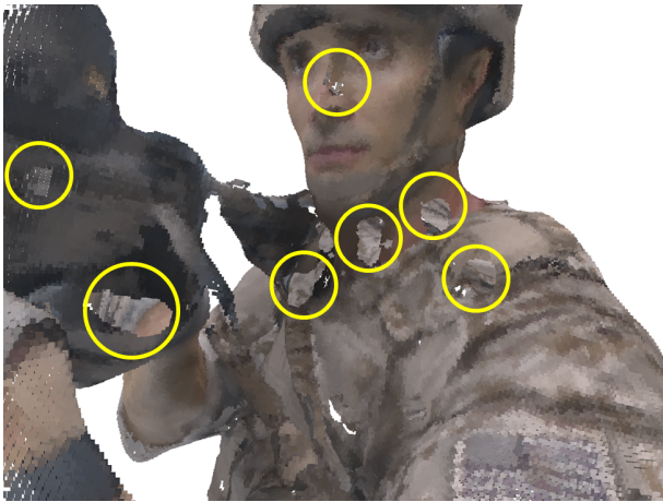
그림 1. AI-PCC의 밀도 저하(홀) 예시 [7] Fig. 1. Examples of hole artifacts in AI-PCC [7]
